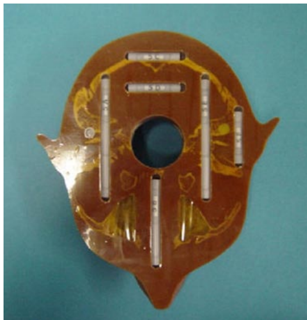
Przekrój głowy fantomu z detektorami (w plastikowych rurkach) i prawdziwymi kośćmi
