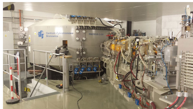
Rys. 1. Cyklotron izochroniczny Proteus C-235. Dostarcza wiązkę protonów o energii maksymalnej 230 MeV do hali eksperymentów fizycznych, hali radioterapii oka oraz do dwóch stanowisk terapeutycznych gantry.
