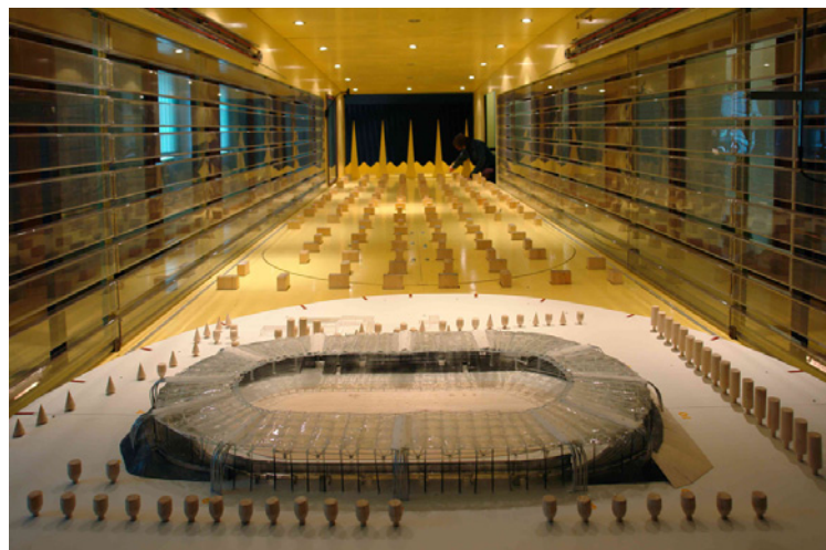
Badanie modelu stadionu w tunelu aerodynamicznym. Fot. Jan Zych.
